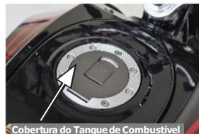
Cobertura do Tanque de Combustível
