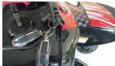
O quadriciclo possui uma chave para ignição e um chaveiro com controle de alarme e localização.
