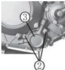
3. Instale o elemento do filtro, a mola, a tampa do filtro de óleo e o tampão de óleo. (Substitua o elemento do filtro ao substituir o óleo do motor)
