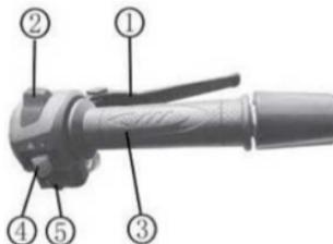
1. **Alavanca do freio dianteiro:** Segure lentamente a alavanca do freio do guidão direito ao acionar o freio dianteiro.
